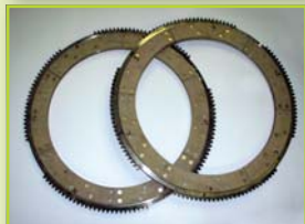
Spojka 610x525x14 mm - výstředníkový lis
