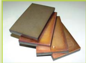
Kovokeramický segment 67x112x11 mm
