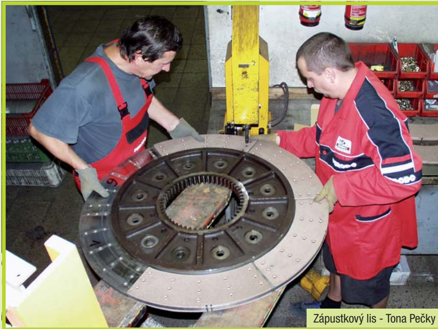
Brzdový pás nýtovaný - segmenty 100x40x12 mm
