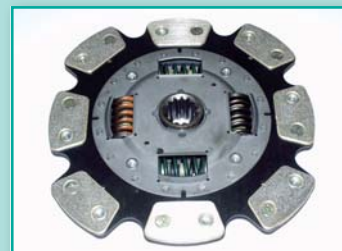
Úprava spojkové lamely OFF ROAD TOYOTA Landcruiser 4,2 TD
