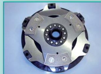
Renovace spojkového kompletu ŠKODA OCTAVIA CUP II, Motorsport Kopecký, Autocentra Hlučín
