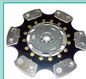
Úprava spojkové lamely ŠKODA FABIA TDi RS
